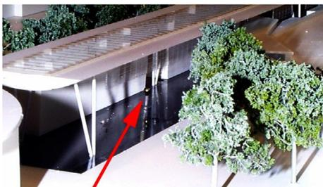
Kugelsonde zur Messung der Böenwindgeschwindigkeiten, eingebaut im Modell einer Fußgängerpassage
